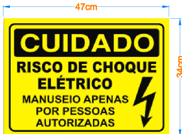
DETALHE - PLACA DE ADVERTÊNCIA A SER FIXADA NA TAMPA DO QUADRO DE DISTRIBUIÇÃO. NOTA:
